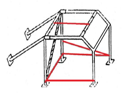
Abbildung zeigt die mind. Anforderung an den Überrollkäfig der OACM, weitere Verstrebung zur Sicherheit des Fahrers sind erlaubt, solange sie keine Rammvorrichtung darstellen
